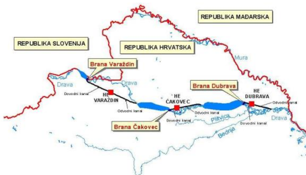
Slika 12: Shematski prikaz hidroenergetskog sustava na rijeci Dravi 91
