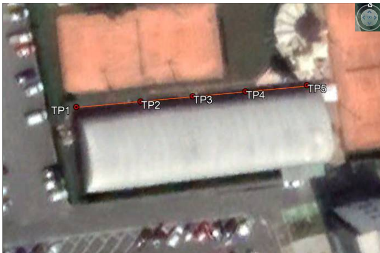
Slika 9. Profil seizmičke tomografije (SRF&MAWS) (TP: točke iniciranja seizmičkog vala)
