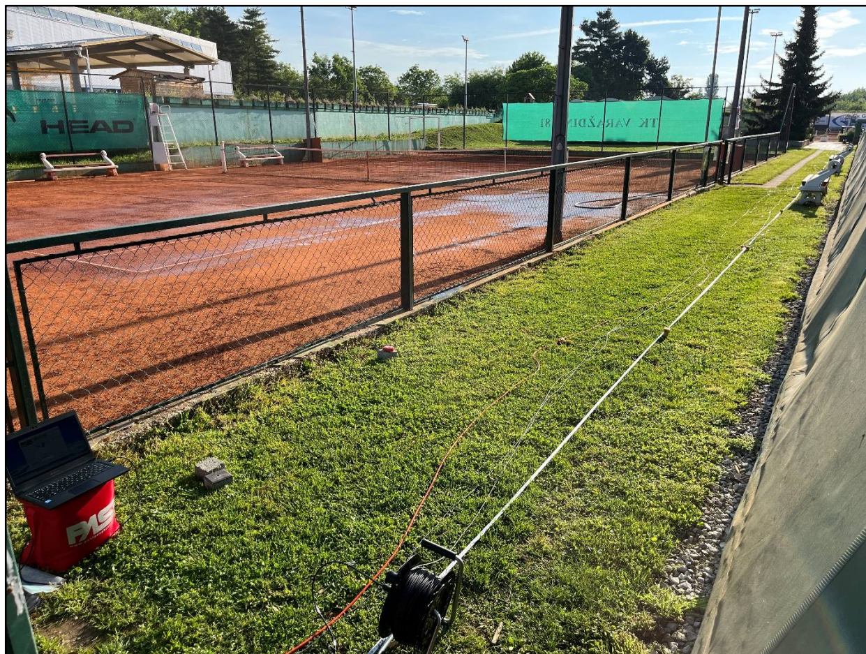
Slika 7. Prikaz geofizičkog ispitivanja/profiliranja temeljnog tla – seizmički profil SP-1
